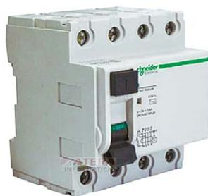
Corrente Diferencial – Residual é uma das medidas obrigatórias prescritas na NBR-5410, e quando instalado de acordo com os padrões técnicos descritos se torna uma medida eficiente de proteção. Segundo o item 5.1.3.2.2 “Qualquer que seja o esquema de aterramento, devem ser objeto de proteção adicional por dispositivos a corrente diferencial-residual com corrente diferencial-residual nominal igual ou inferior a 30 mA.”
