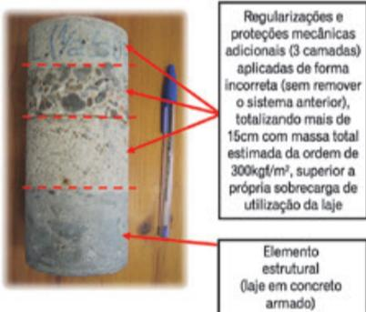
Regularizações e proteções mecânicas adicionais (3 camadas) aplicadas de forma incorreta (sem remover o sistema anterior), totalizando mais de 15cm com massa total estimada da ordem de 300kg/m<sup>2</sup>, superior a própria sobrecarga de utilização da laje
