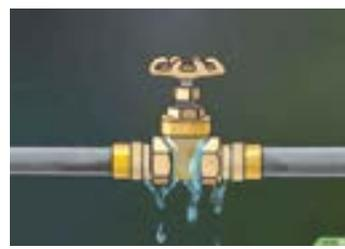
água. Sendo assim, sua função é dosar o quanto de água passará pela tubulação. Diferentemente do registro de gaveta, ele é mais indicado para equilibrar a quantidade de água em saídas de torneiras e chuveiros, por exemplo.
