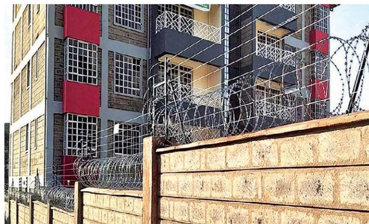
Há dois modelos que são frequentemente usados em condomínios: o primeiro é a cerca elétrica convencional (feita de hastes verticais ligadas entre si através dos isoladores por fios de aço inox) e a segunda é a cerca elétrica concertina (feita com arame farpado de alta tensão de ruptura, em formato de espiral, contendo lâminas de aço perfurantes e cortantes). Nelas, a tensão elétrica elevada, entre 8 a 12 mil volts, percor-
